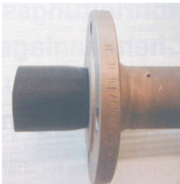
Rys. 4 Wykładzina PTFE osadzona w rurze stalowej
