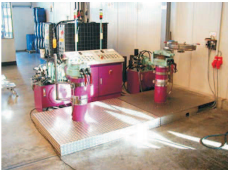
Rys.2 Prasowanie sproszkowanego PTFE w cylindrach
